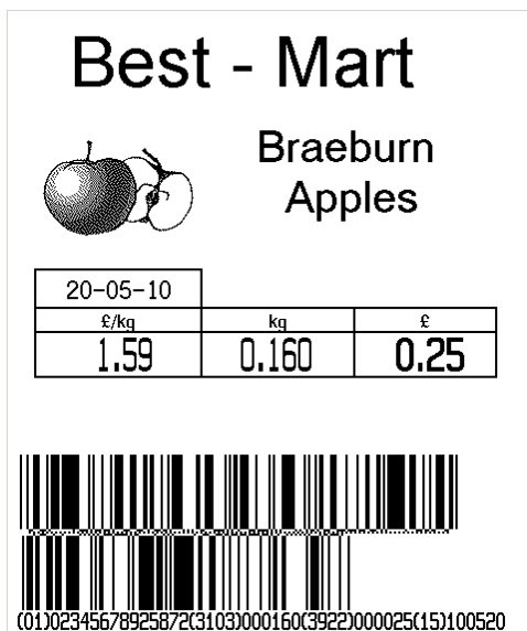
Attēls 4-2 Paredzamā etiķete, izmantojot GS1 DataBar paplašināto salikto svītrkodu, kurā iekodēts GTVN plus papildu dati
